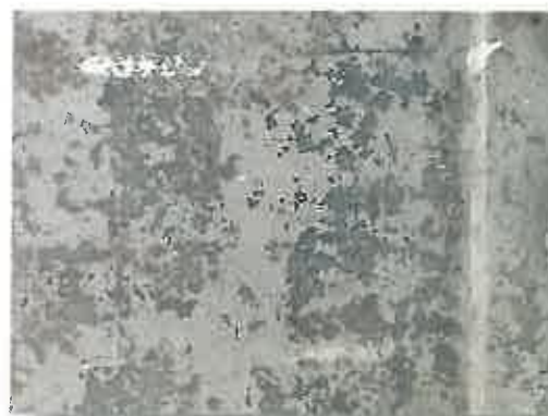
Εικόνα 76, 77. Η πίσω πλευρά της θύρας η οποία εμφανίζει διάβρωση και απώλεια των χρωματικών επικαλύψεων.
